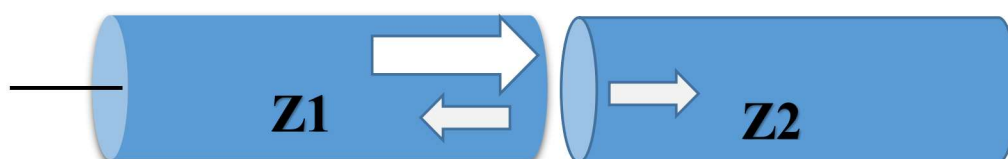
図5 同軸ケーブルでの反射と透過
